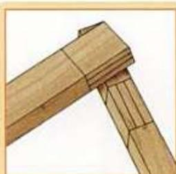
**2** Luego con el ancho de la caja ya marcado, volver a marcar en el sector donde se introducirá la espiga.
