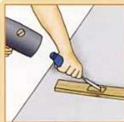
**5** Con el formón y la maza de madera comenzar a retirar la madera sobrante para realizar la caja del encastre de la espiga.
