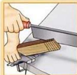
**4** Con el serrucho de costilla, cortar y retirar las partes marcadas.
