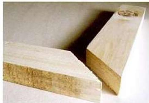
Corte de madera realizado con la caja para ingletar
