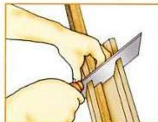
**3** Con una mano sujetar bien la varilla y con el serrucho de costilla realizar el corte, cuidando de no deslizar la pieza hasta finalizar el trabajo, como se observa en el dibujo.
