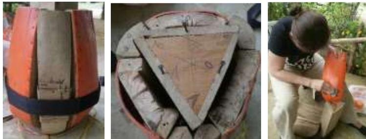
En algunos moldes, el armazón central tenía puntillas que era poco ergonómico, sustituyéndose por una manija que facilita su manipulación. Se pulieron con lija las partes del molde en su curvatura, para mejorar defectos y se les colocó cinta topex, para dar la forma requerida.
