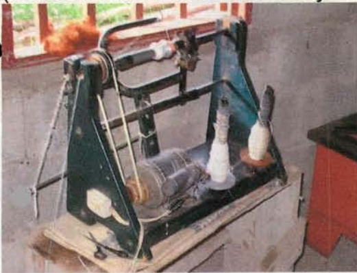
implementacion de maquinaria de mayor capacidad (retorcedora de 3 usos diseñada y fabricada por un tecnico del sena)
