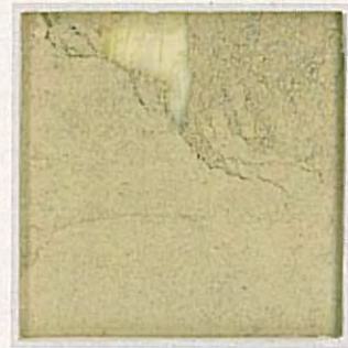
MEZCLA DE LAS DOS ARCILLAS EN PARTES IGUALES
