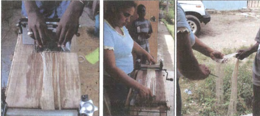
Taller artesanal, Turbo 2006 – Desfibrado de calceta en superficie de madera – D.I Manuel Abella
