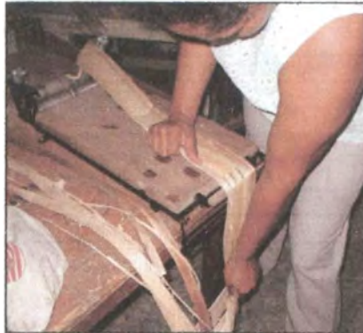
Artesanas de las Banancras de Uraba, Turbo 2006 – Proceso de Corte con cuchil las graduables.
