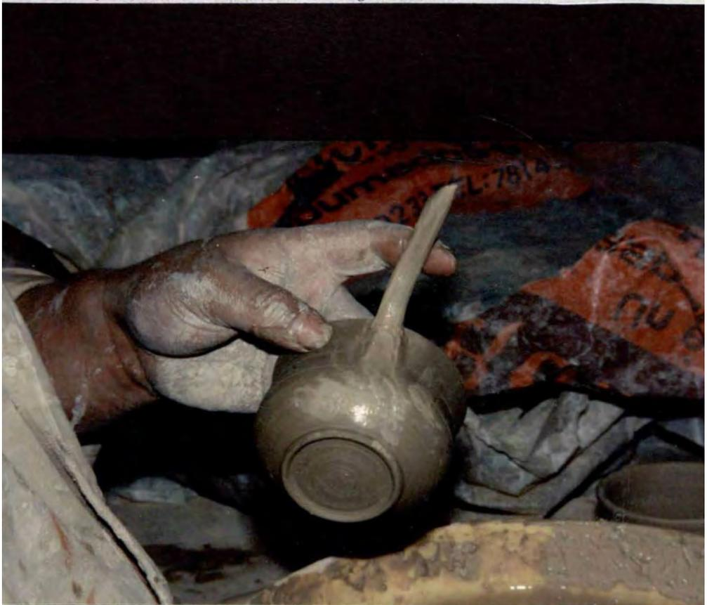
*Fijación del rollo a la pieza.*
