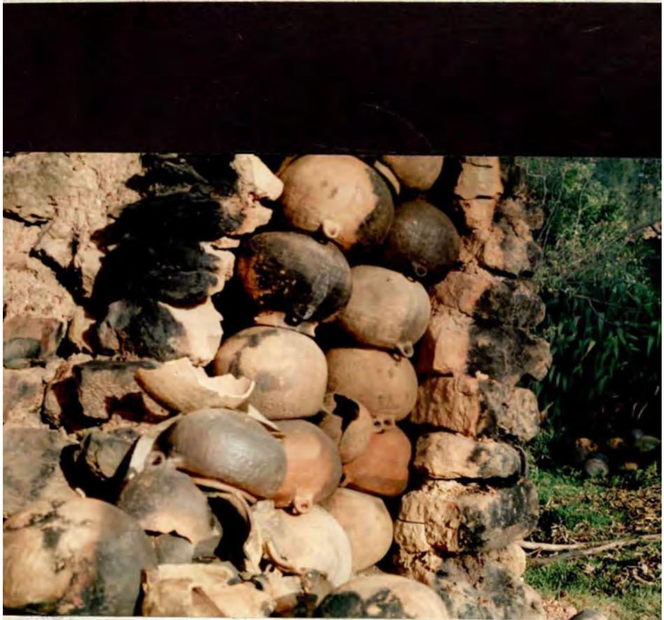
*Sellado del horno con barro v ollas.*
