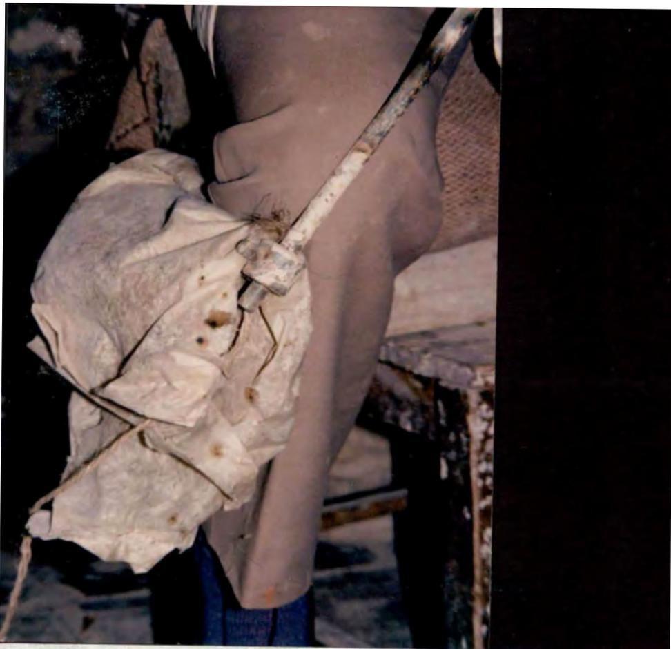
Las revoluciones del torno se manejan con un control de rodilla.
