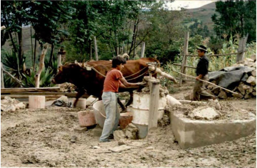
*En el molino se adiciona agua y barro seco y molido para homogenizar la mezcla.*
