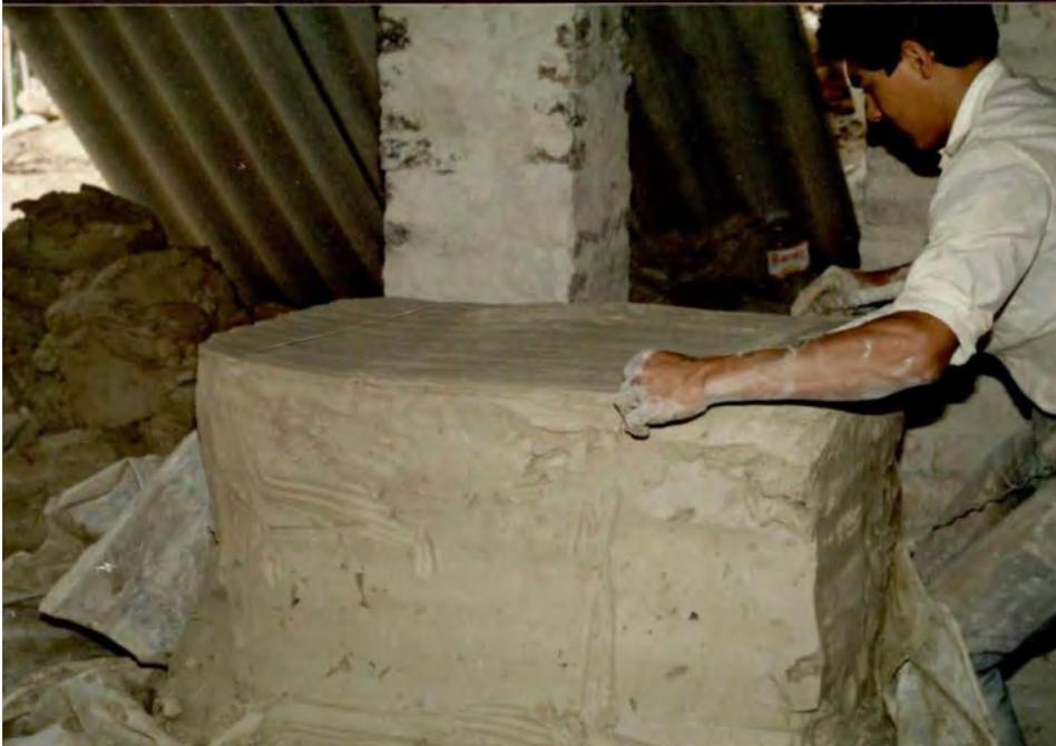
*Del bloque amasado se toma una lámina con un cortador.*
