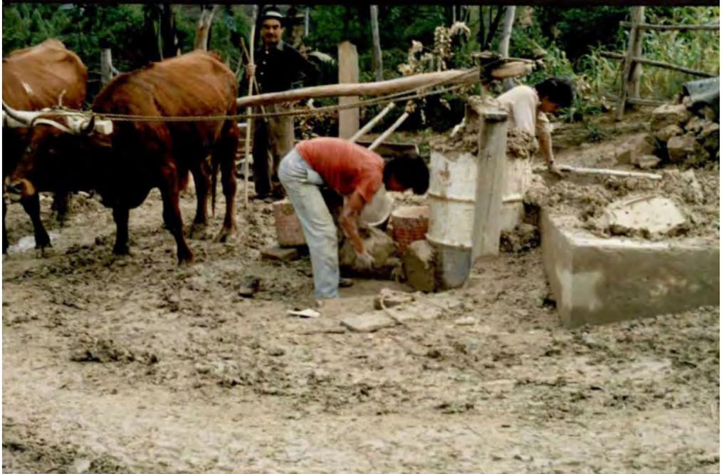
*El barro molido empleando yunta de bueyes o mulas, va saliendo en bloques por la boca inferior de la caneca.*
