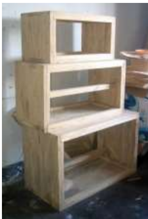
Moldes para contenedores rectangulares, armados por ensamble de tejidos.
