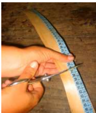
Medición y corte longitud de cintas
