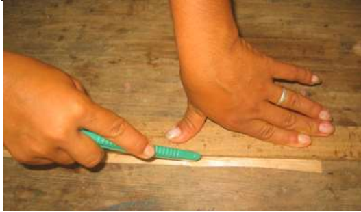
Corte de cintas con cortador es más limpio, no deja residuos
