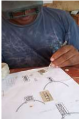
Tomada por : Sandra Uribe Lugar: Taller Asojobar Fecha : 16/05/2012 Descripción: armado de filigrana con chapa según diseños
