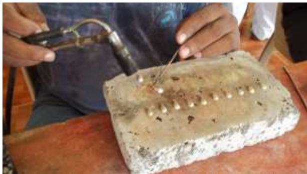
Tomada por : Sandra Uribe Lugar: Taller Asojobar Fecha : 16/05/2012 Descripción: Soldando piezas en chapa embutida
