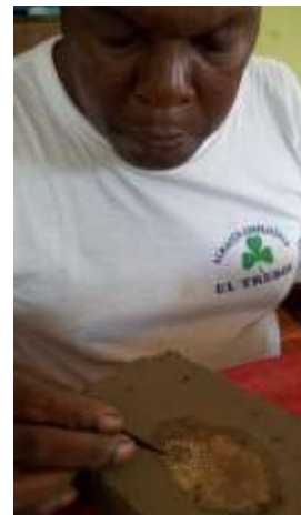
Tomada por : Sandra Uribe Lugar: Taller Asojobar Fecha : 16/05/2012 Descripción: Soldando armazón para anillo
