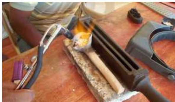
Tomada por : Sandra Uribe Lugar: Taller Asojobar Fecha : 15/05/2012 Descripción: Fundición de plata
