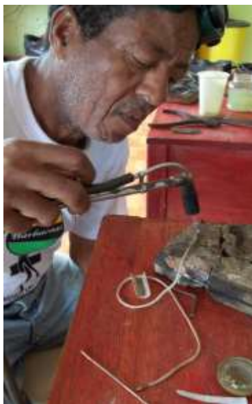
Tomada por : Sandra Uribe Lugar: Taller Asojobar Fecha : 18/05/2012 Descripción: soldadura broche de cadena
