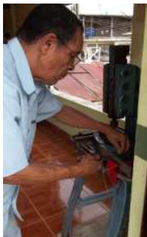
Tomada por : Sandra Uribe Lugar: Taller Asojobar Fecha : 16/05/2012 Descripción: Estirando hilo para filigrana
