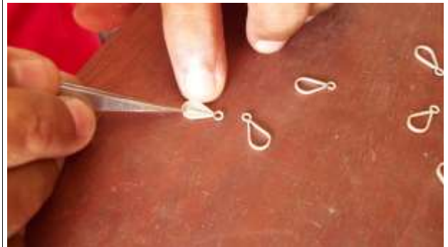
Tomada por : Sandra Uribe Lugar: Taller Asojobar Fecha : 15/05/2012 Descripción: relleno con “churos” de filigrana
