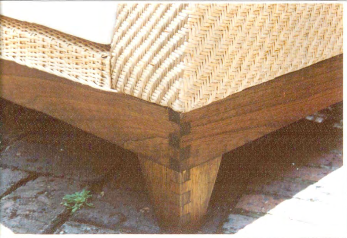
Detalles estructurales del Sofá Tejido Espina de Pescado, la base en madera de cedro con ensamble ondado, y tejido en mimbre y vare plano, contraste de color y dirección.
