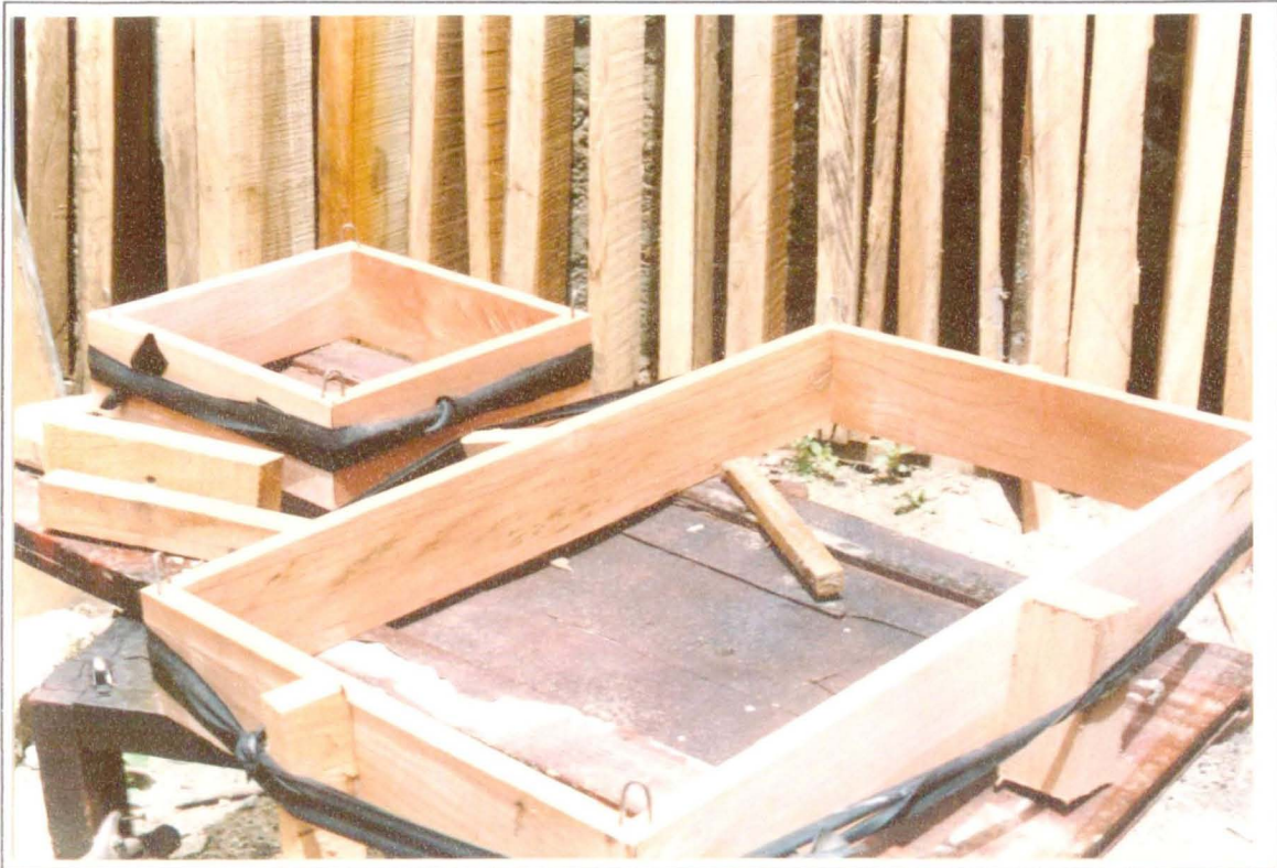
Proceso de elaboración de la línea de mesas auxiliares y de centro en madera de cedro: armado, eridantado, ajuste, torneado. Taller del artesano justo Pastor Mora.
