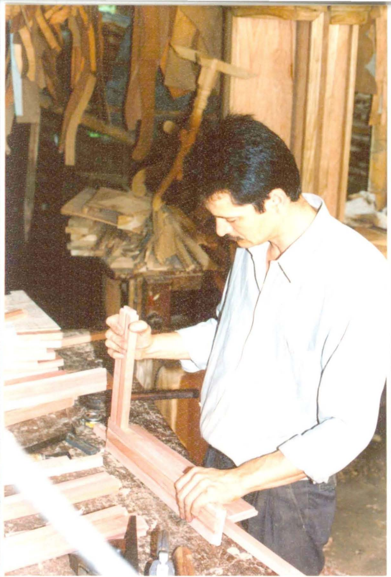
Proceso de elaboración de la línea de mesas auxiliares y de centro en madera de cedro: armado, endentado, ajuste, tomeado. Taller del artesano justo Pastor Mora.
