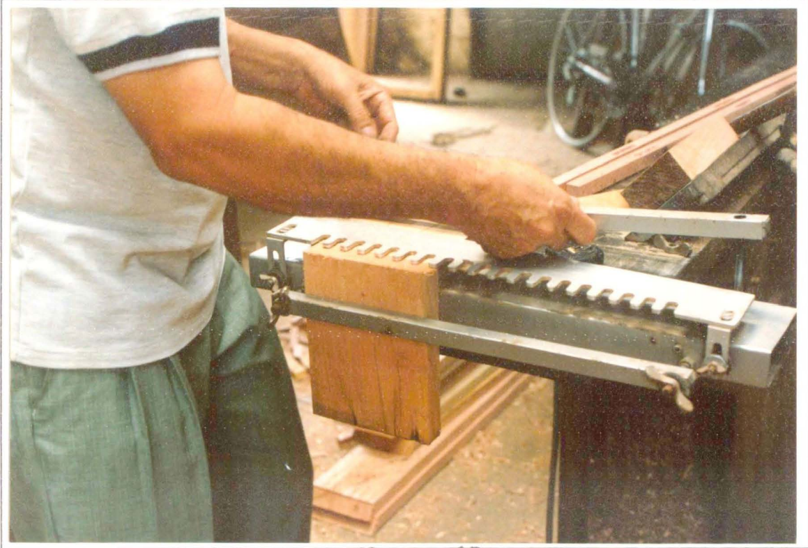
Proceso de elaboración de la línea de mesas auxiliares y de centro en madera de cedro: armado, eridantado, ajuste, torneado. Taller del artesano justo Pastor Mora.
