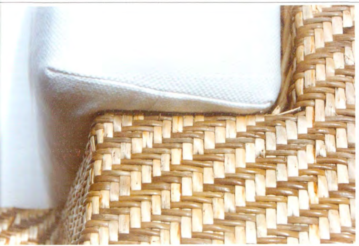
Detalles estructurales del Sofá Tejido Espina de Pescado, la base en madera de cedro con ensamble ondado, y tejido en mimbre y vare plano, contraste de color y dirección.
