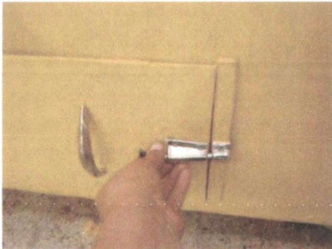
Foto 14: Compuerta dispensadora de Azufre. Foto de Luz Dary Rosero
