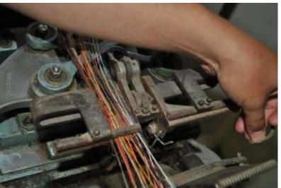
Telar de Agujas para elaboración de reatas en algodón y fique: requiere implementación y capacitación. Repuestos y mantenimiento.
