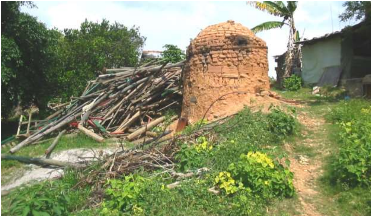
Horno Tradicional de leña utilizado por los artesanos de Palomitas (Floridablanca).
