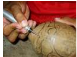
11 TALLANDO CON MOTOTOOL CON FRESA DE ACERO RÁPIDO
