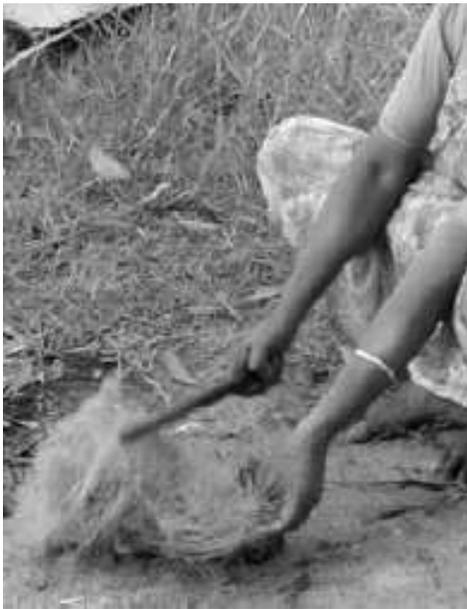
Como paso siguiente a la inmersión de las cortezas en agua viene la extracción en sí de la fibra. Tradicionalmente, el trabajador debe golpear la cáscara (**Ilustraciones 12 y 13**) recién salida del agua, repetidamente con una estaca o vara de madera con el fin de separar las fibras de la cutícula externa y del entremés o médula que mantiene las fibras unidas entre sí.
