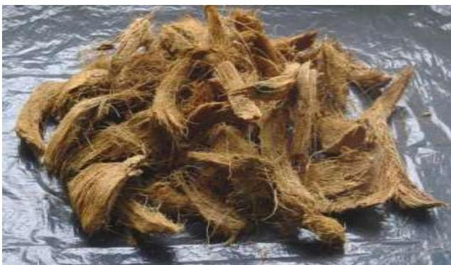
Las fibras que provienen de cáscaras obtenidas mediante “tusado” son de corta longitud debido a la acción repetida del machete sobre la corteza, en cambio las que provienen del primer método son mas largas, dependiendo de la destreza del
