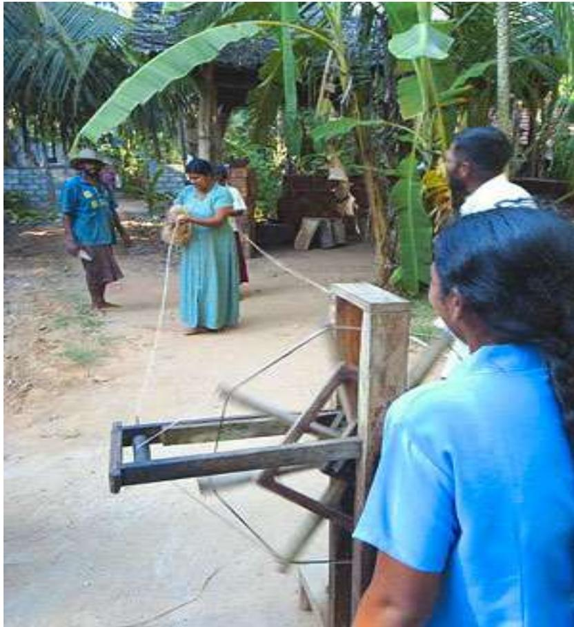
**Ilustración 18:** hilado mediante rueca adaptada para 2 hilanderas
