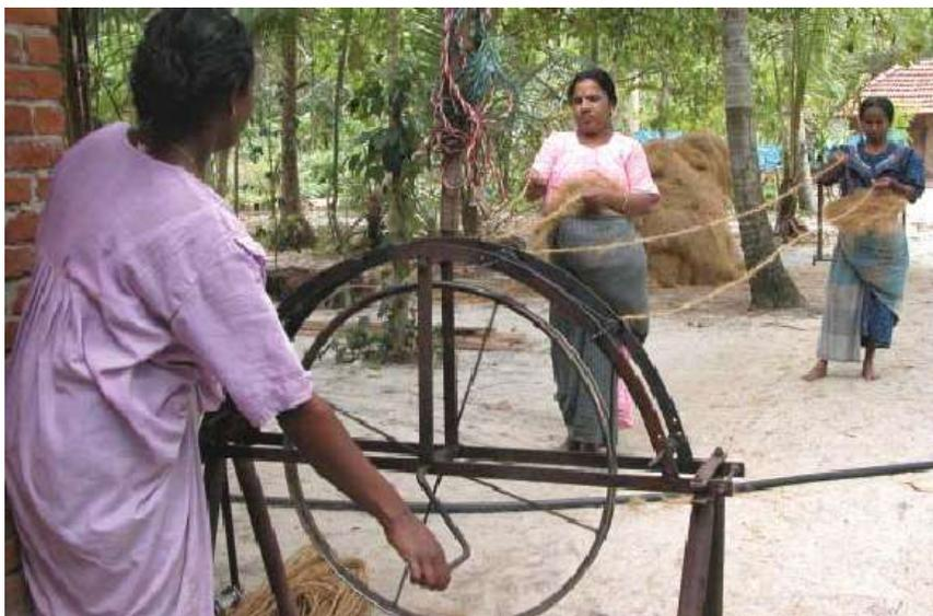
**Ilustración 19:** Accionamiento manual de una rueca de 4 husos
