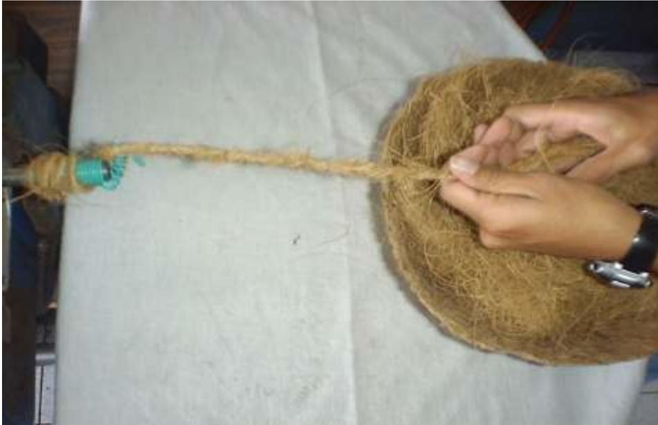
Ilustración 17: Hilado mediante motor de baja velocidad
