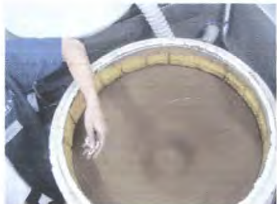
Fig. 21 Centrifuga de brillo para oro.
