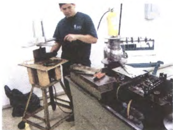
Fig. 34. Trefiladora con varios palacios de Reducción del calibre del hilo.
