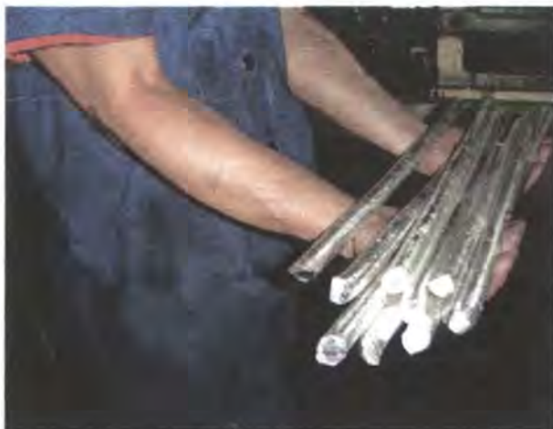
Fig.4. Alambres fundidos en horno continuo. Atmósfera controlada.
