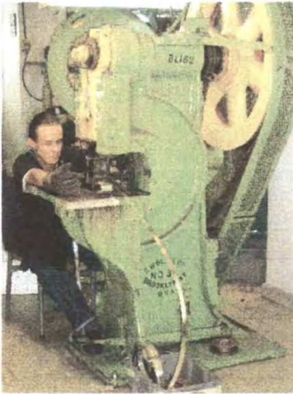
Fig. 12. Troqueladora de corte y estampado simultáneos.
