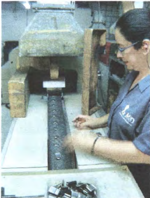
Fig. 14. Horno de soldadura de banda.
