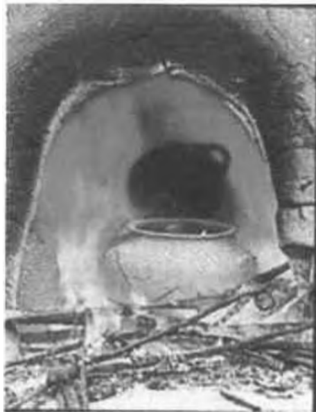
Foto 36. Quema sin ningún tipo de puerta que permita aislamiento de calor
