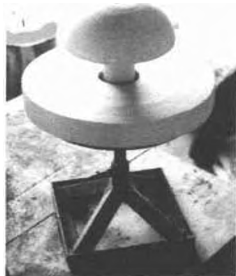
Foto 21. Molde elaborado en yeso torneado
