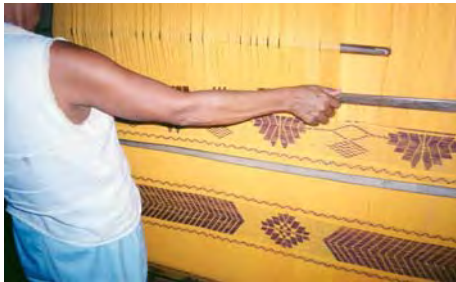
Proceso de tejeduría, paso de la paleta
