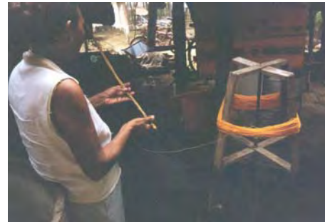
Proceso de encañuelar la lanzadera
