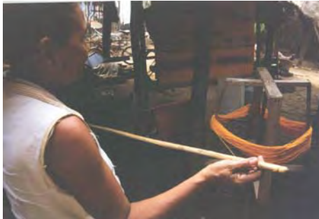
Proceso de encañuelar la lanzadera
