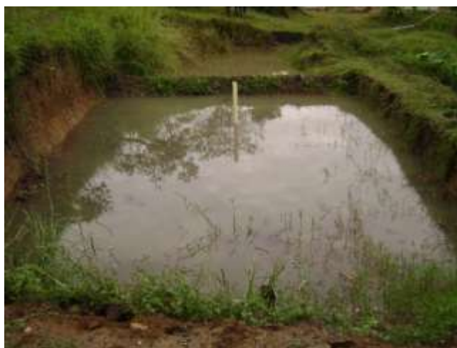
Foto 3: estanque con fangueo para la prueba de impermeabilizado
