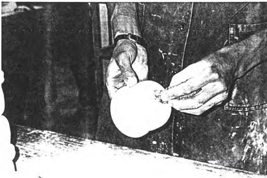
Las partículas metálicas y del esmaite que se desprenden con esta frotación de la pieza contaminan el ambiente y pueden adherirse al objeto esmaltado.
