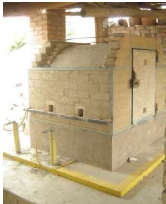
Horno a Gas Natural Domiciliario
