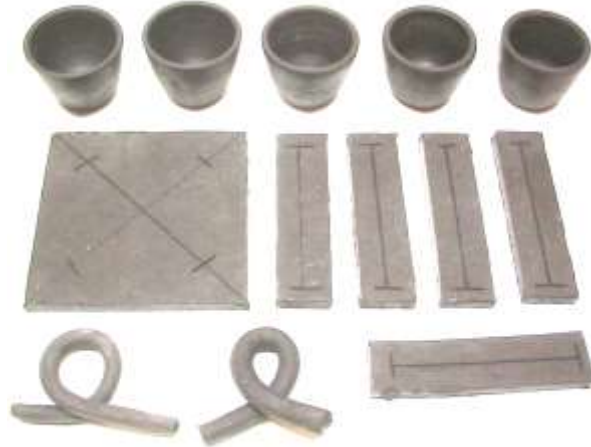
Muestra de Análisis de pruebas físicas de las arcillas
