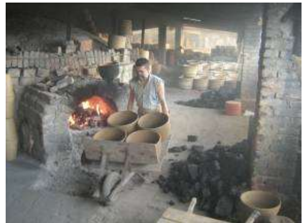
Carga de Piezas en Horno a Carbón
