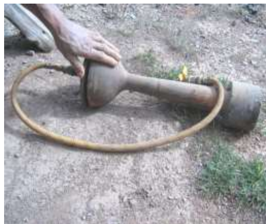
Quemador atmosférico para Gas Propano o Gas Natural
