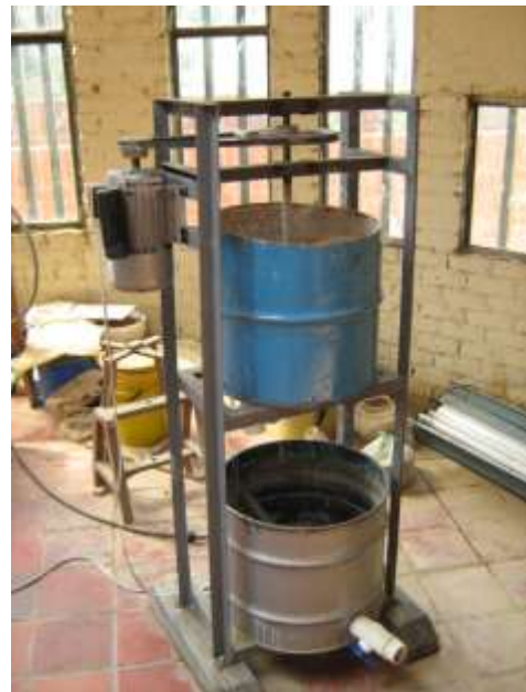
Extrusora de Arcilla para Bloques
