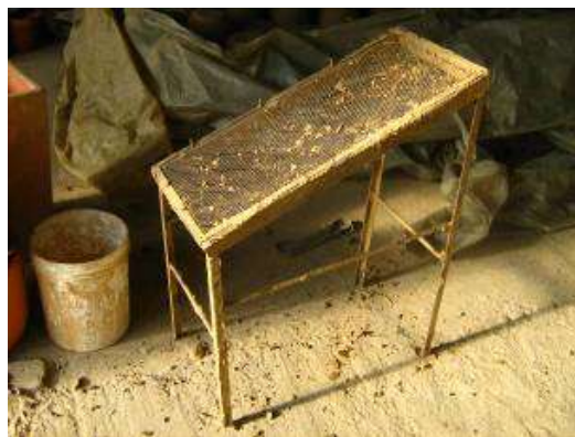
Mueble Metálico de Rallado con Malla Metálica
