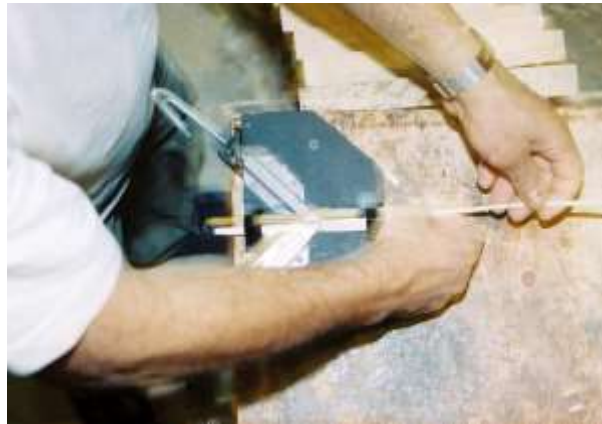
Herramienta descortezadora mimbre-Silvania
