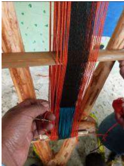
Tomada por : Rosnery Pineda Cubides Lugar: Resguardo Indígena La María, Piendamó - Cauca Fecha : 10/2012 Descripción: Separación de hilos de urdimbre por color para realizar diseño por urdimbre.
