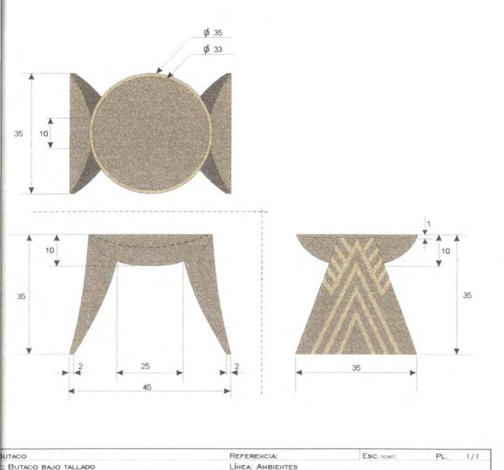
O DE PRODUCCIÓN: SE TOMA EL BLOQUE DE MADERA Y SE DA LA FORMA INICIAL TACO HACIENDO LOS CORTES PRINCIPALES CON UNA SIERRA LUEGO SE EMPIEZA CESO DE TALLA DANDO PAULATINAMENTE LAS CURVAS Y FORMAS DEL BUTACO. DO ESTE PROCESO SE PULE EL BUTACO CON UNA LIJA NO. 100 QUE ESTA EN UN ESMERIL.
