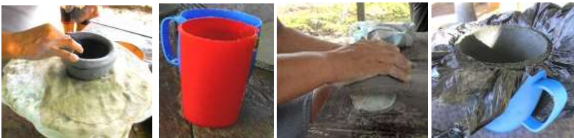
Producción inicial de pocillo. Moldes implementados y producción estandarizada de piezas.
