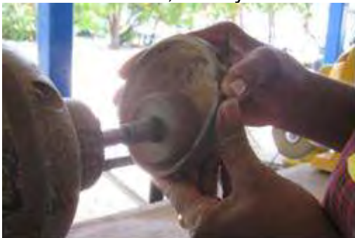
Proceso de pulimiento interno. Artesanías de Colombia S.A. 2010 San Andrés Islas Fotografía: Juan G. Peláez.
