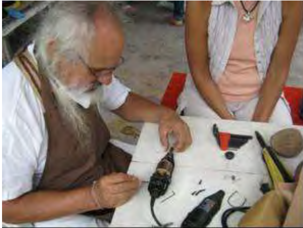
Revisión del estado del esmeril eléctrico y del estado interno del motortool Artesanías de Colombia S.A. 2010 San Andrés Islas Fotografía: Juan G. Peláez.
