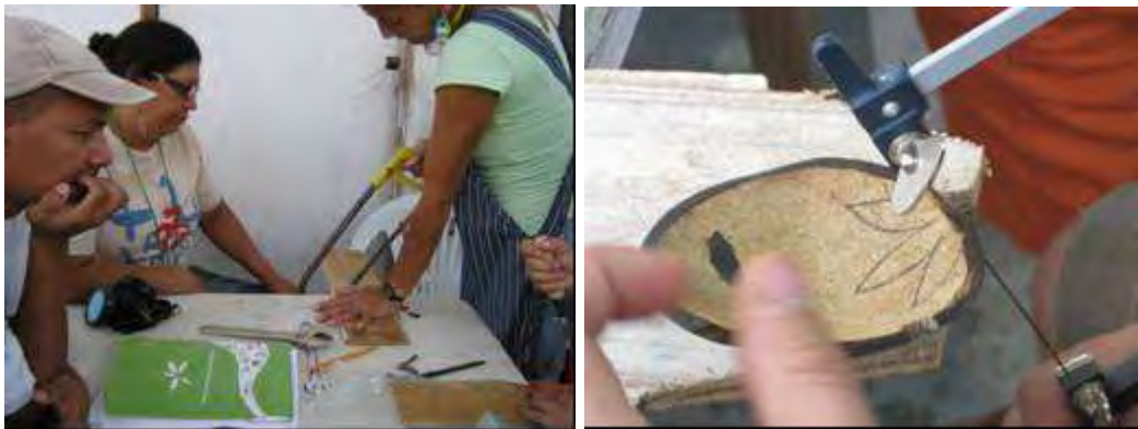
Proceso implementación del soporte de corte y proceso de calado manual. Artesanías de Colombia S.A. 2010 San Andrés Islas Fotografía: Juan G. Peláez.
