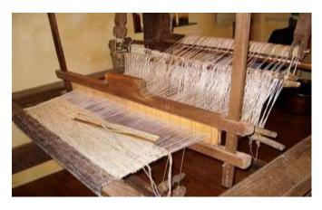
El tejido del telar horizontal posee dos elementos: una urdimbre, que son una serie de hilos puestos en forma paralela y que se alistan en forma longitudinal en el telar a través de la utilización del tambor, lisos o agujas y peine.
