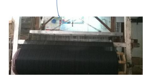
**Urdidor:** sistema manual, gracias al cilindro que tiene, se usa para lograr el metro y ancho de la tela.
