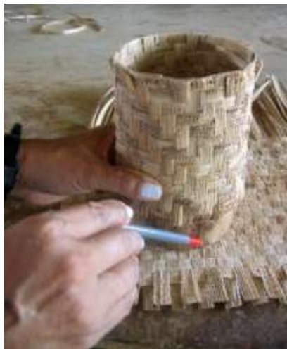
El tejido (cuerpo del producto) se envuelve en el molde y se tiene otro tejido para la base
