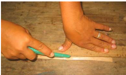
Corte de cintas con cortador es más limpio, no deja residuos
