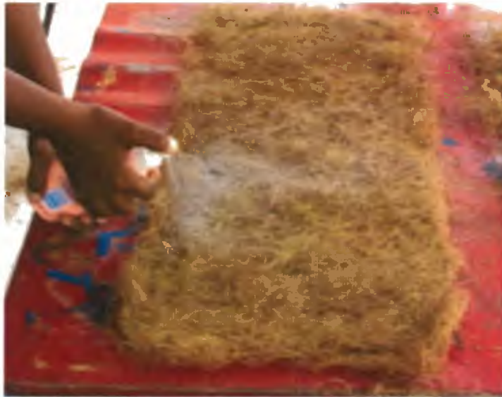
Foto 15: Aplicación del látex sobre la fibra
