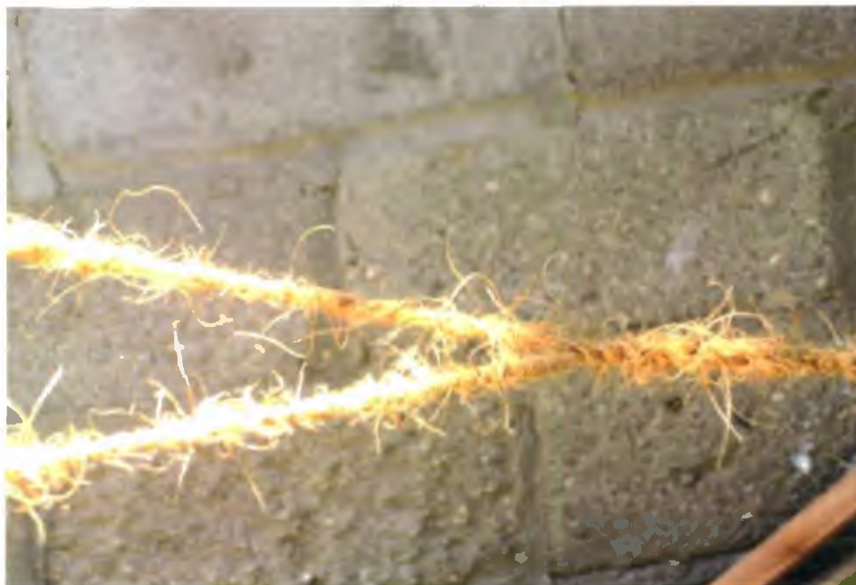
Foto 24: Proceso de enrollado de una cuerda sobre la otra
