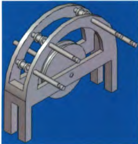
Ilustración 21 : Esquema de una rueca de 4 husos. A:Vista del conjunto. B:Vista de atrás
