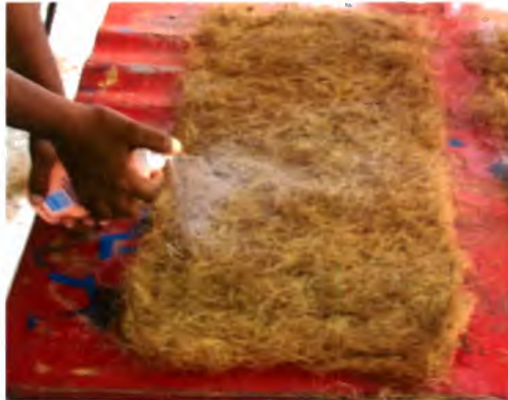
Foto 14: Aplicación del látex sobre la fibra
