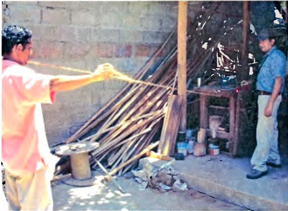
Foto 6: Conformado de cuerdas de mayor grosor
