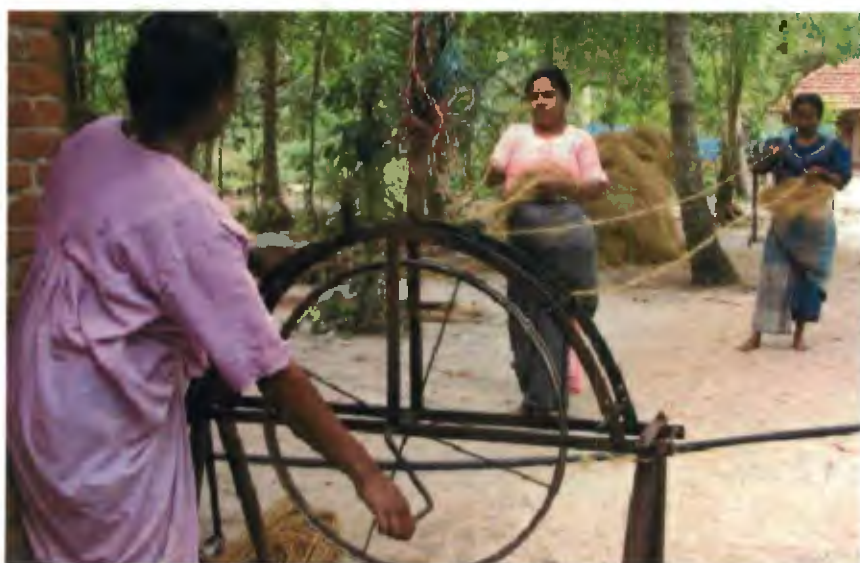
Ilustración 19: Accionamiento manual de una rueca de 4 husos
