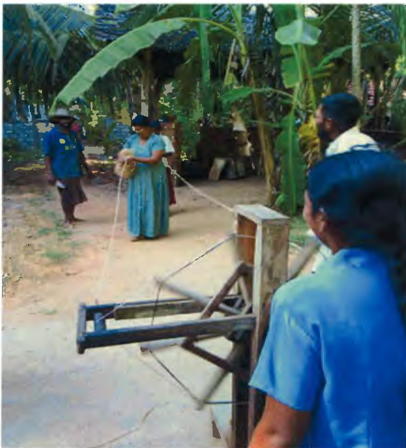
Ilustración 18: hilado mediante rueca adaptada para 2 hilanderas
