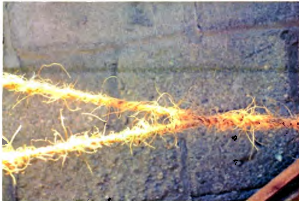
Foto 7: Proceso de enrollado de una cuerda sobre la otra
