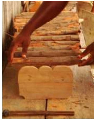
Tomada por : CAROLINA BERMUDEZ Lugar: Guapi-Cauca Fecha : 18/10/2011 Descripción: Artesano hacedor de marimbas. Elabora las plaquetas de este instrumento musical utilizando la madera de la palma de chonta.
