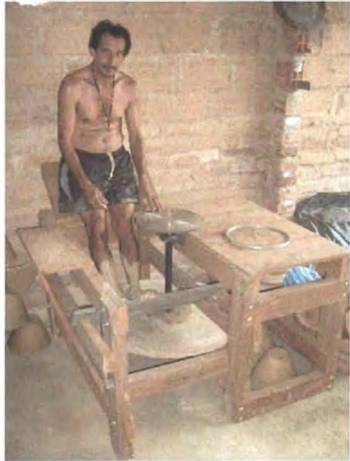
Foto 18 Marco Aníbal Flores en torno De patada diseñado nuevo y construido.
