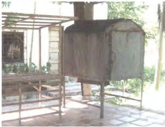
Foto 143 Horno A Gas GLP.
