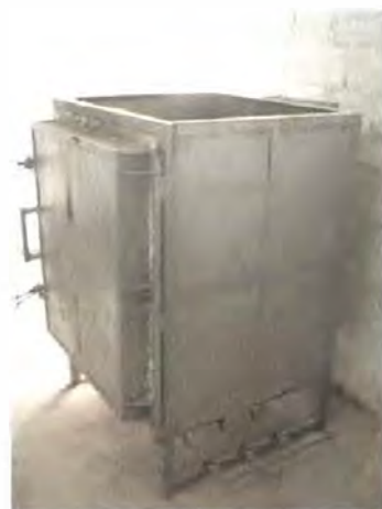
Foto 44 Horno a gas GLP 2
