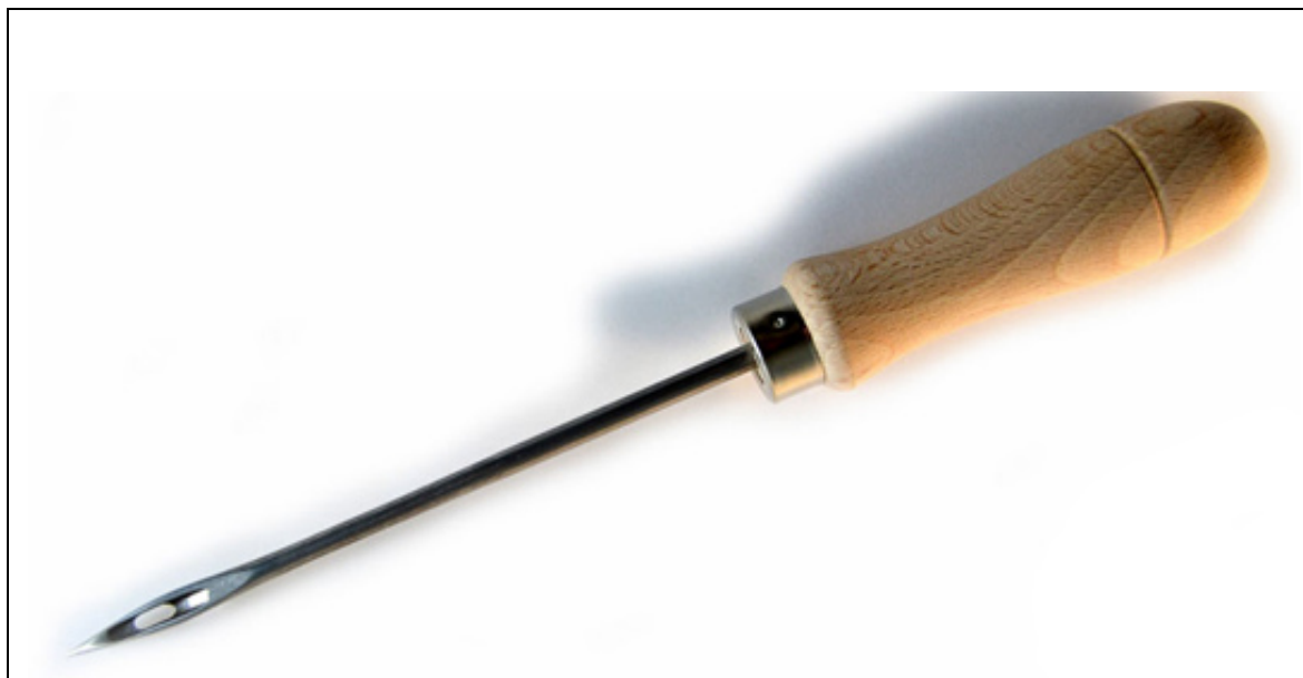
Herramientas – Leznas Villapinzón, Noviembre 2015 - DI. Karly Paola Osorio Sandoval Cedavida – Artesanías de Colombia
