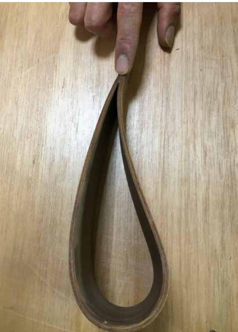
La técnica al vapor consiste en calentar la madera en un horno steambox, una estructura en la que se introduce la pieza a una temperatura de 99°C. Al alcanzar esta temperatura, la lignina (componente de la pared celular que mantiene la dureza de la madera) pierde resistencia y el material se vuelve maleable. Por último, se saca del steambox y se grapa la pieza al molde y se espera a que se enfríe y se seque (Souza, 2020).
