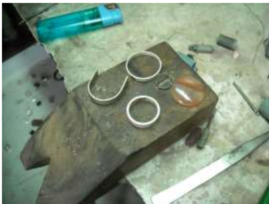
Lugar: Ataco. Fecha : Junio de 2009 Descripción: Pieza en proceso de engaste utilizando el de bisel.
