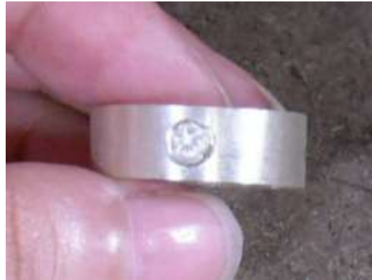
Lugar: Ataco. Fecha : Junio de 2009 Descripción: Pieza terminada con engaste invisible a bisel.
