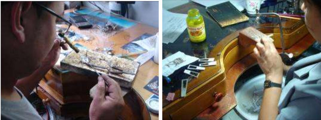
Proceso de calado, laminado y soldadura
