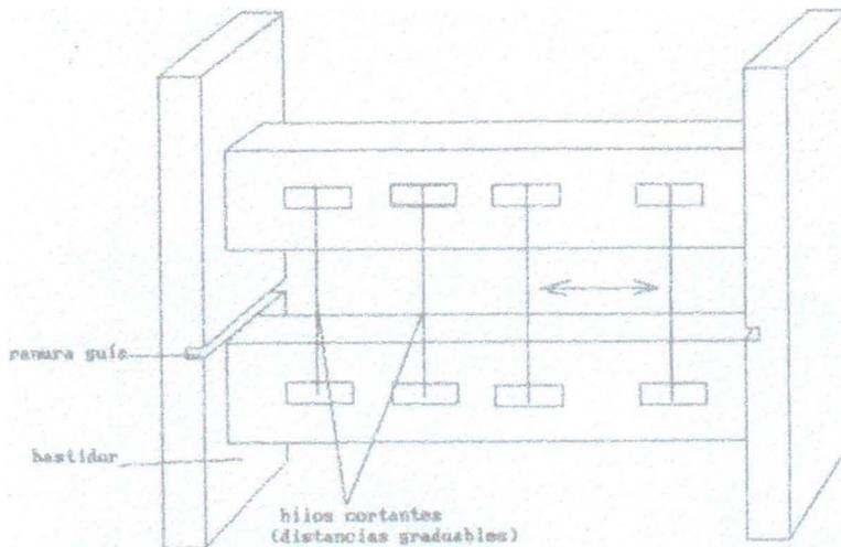
Esta herramienta consta de un bastidor sobre el cual se disponen hilos cortantes de metal cáñamo o nylon, a distancias graduables.
