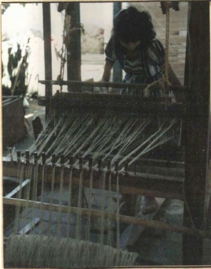
Dispensador de las fibras bases para el saco montadas sobre el telar.
