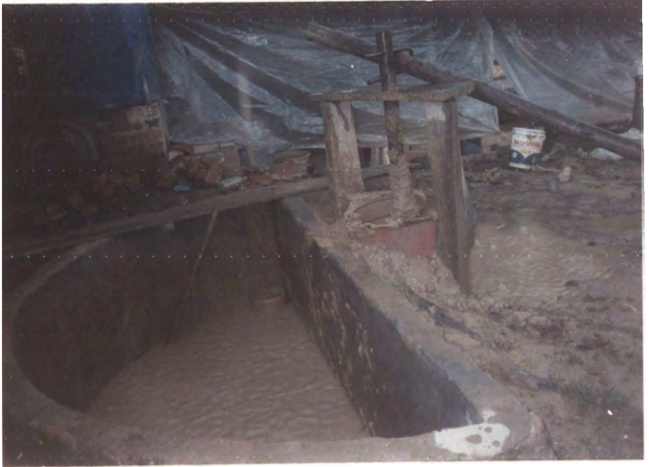
Figura 7. Preparación de la arcilla. Unidad Productiva ubicada en el municipio de Ráquira.
