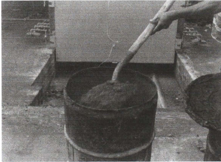
Descargue del horno y negreado
