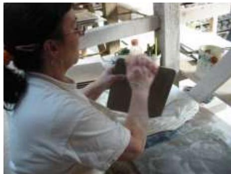
Posteriormente se procede al pulido de la pieza, se pule con un cuchillo recortando las rebabas y huellas de uniones en los moldes, luego se empareja con una esponja húmeda, se debe procurar pasarla siempre en un solo sentido.
