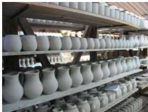
Luego se deja secar totalmente en una estantería. Las piezas durante el secado siempre deben estar colocadas sobre superficies de madera,
