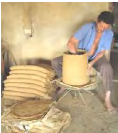
Técnica de rollos para elaboración de productos Detalle de técnica de “armado” de piezas
