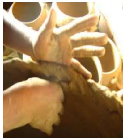
Técnica de rollos para elaboración de productos Detalle de técnica de “armado” de piezas
