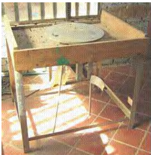
Torno de Levante Eléctrico
