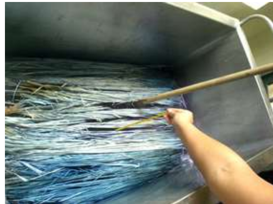
Fotos 19 y 20: Medición del tinte proporcional a la fibra que se tinturará y control de temperatura (Fotografía Luz Dary Rosero Alvarez)
