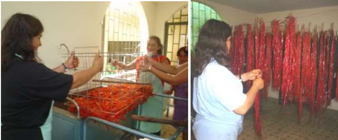
Fotos 46 y 47: Extracción de la fibra tinturada y secado (Fotografía Luz Dary Rosero Alvarez)
