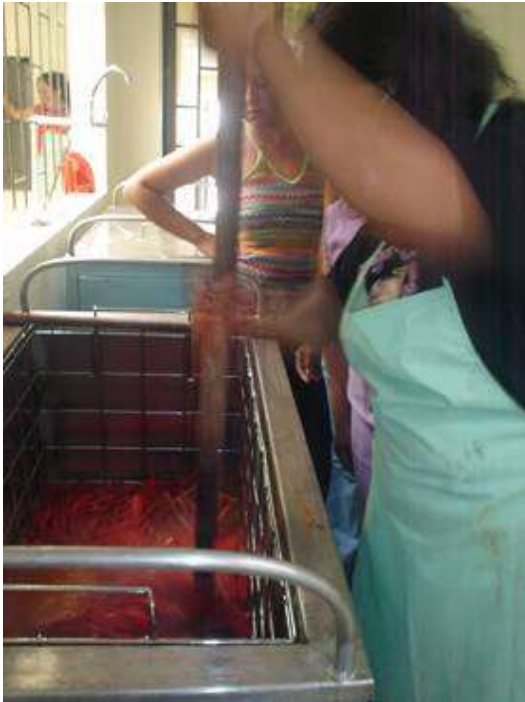
Fotos 44 y 45: Artesanas Proceso de tinturado. Obtención de fibra tinturada en color salmón (Fotografía Luz Dary Rosero Alvarez)
