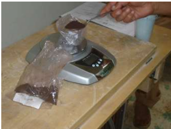
Fotos 19 y 20: Medición del tinte proporcional a la fibra que se tinturará y control de temperatura (Fotografía Luz Dary Rosero Alvarez)
