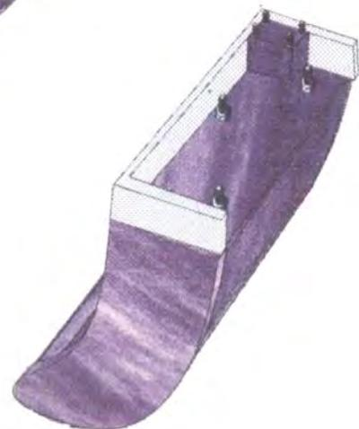
Sistema de armado, parte estructural de los apoyabrazos de el Divan y la silla escuadra. Se cortan los travezaños y loego se disponen en forma de plano seriado generando la curva del apoyabrazo.
