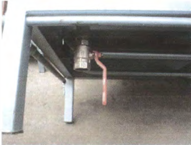
desagüe de 2" en la parte inferior de la olla.
