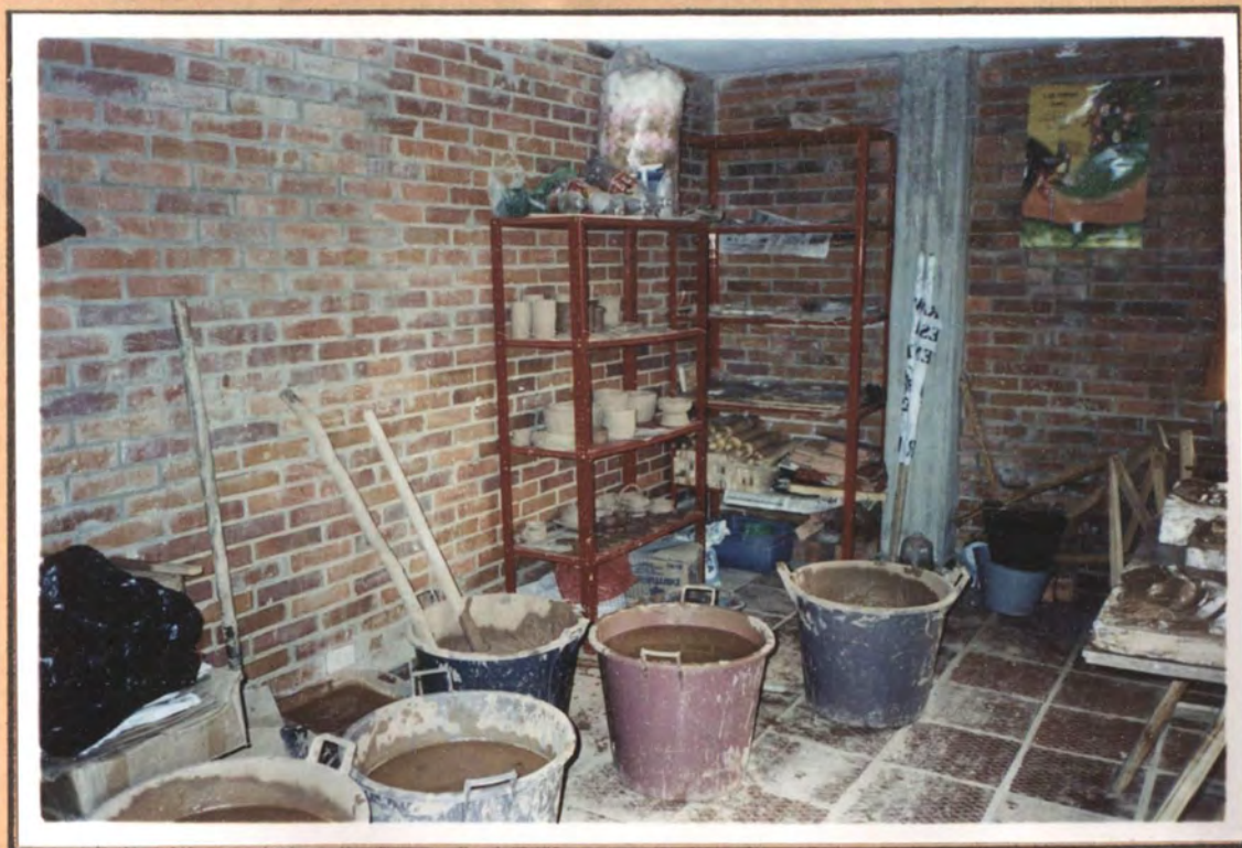
Zona de almacenamiento y procesamiento de la arcilla.
