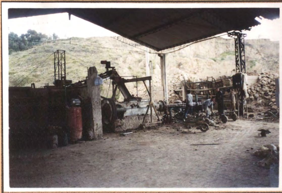
Jóvenes trabajando en las ladrilleras. Maquina de procesamiento de la arcilla y elaboración de los ladrillos.
