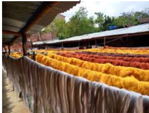
Foto 9:: Secado de fibra al aire libre
