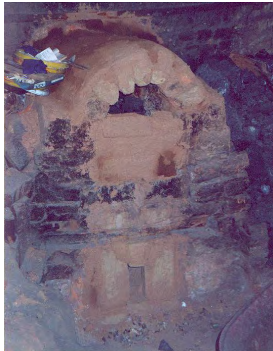
Cámara de combustión reconstruida con ladrillo de alumina
