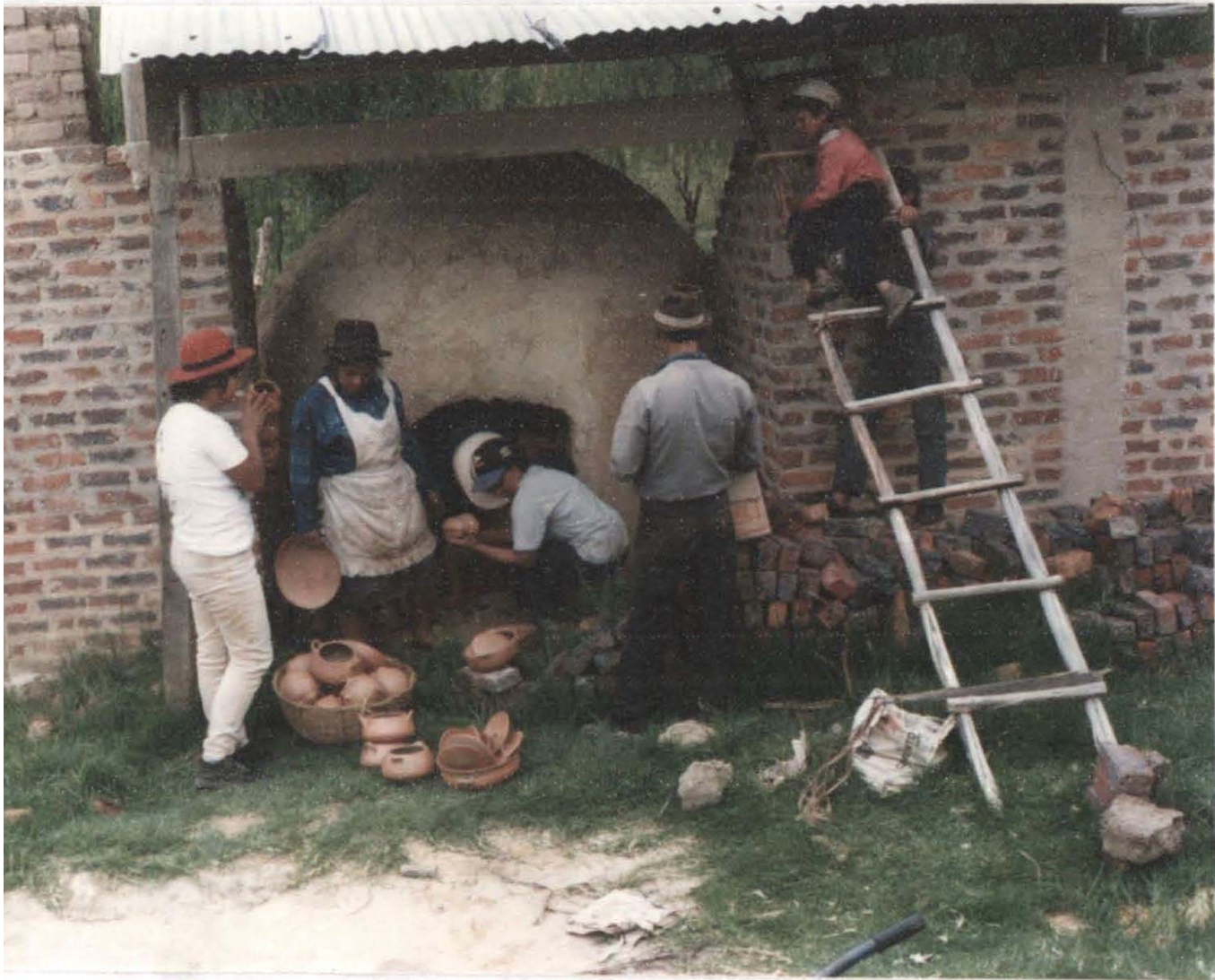
Artesanas colocando los productos en el horno para realizar la quema
