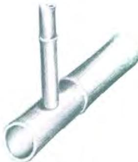
Cuando las guaduas son del mismo diámetro, se usa un tarugo de madera con el grosor del diámetro interno y se introducen como una extensión entre ellas, debe r~ftW6iarse
