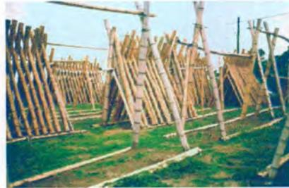
**Secado natural:** al aire libre, en condiciones no controladas colocando o apilando los tallos horizontalmente bajo cubierta, expuestos a una atmósfera secante, pero protegidos del sol y de la lluvia finalizando cuando se alcance la humedad en equilibrio y mediante inspección visual del color de la guadua.
