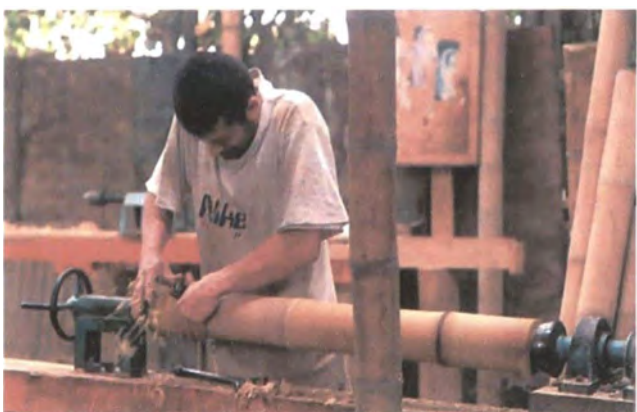
Asistencia técnica - Torno para pulir la guadua.
