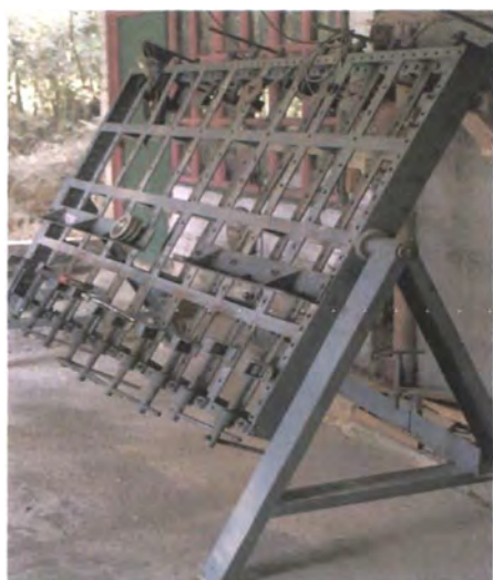
Prensa mecánica de operación manual para la elaboración de la tabilla.
