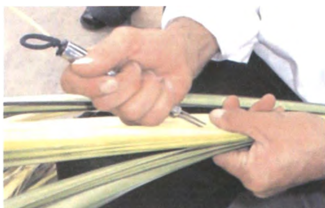
Asistencia Técnica Ripiadora ergonómica con compartimiento para guardar varias agujas.
