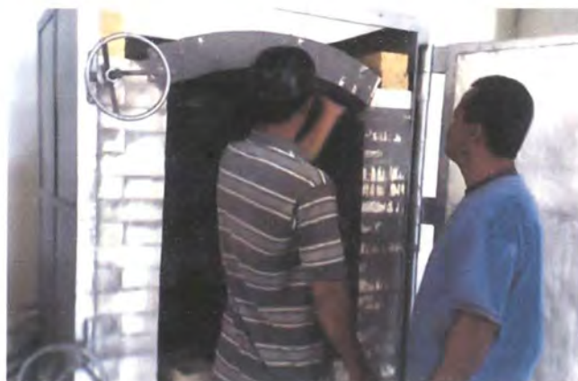
Horno a gas en Pitalito Huila para reemplazar 22 hornos de leña.
