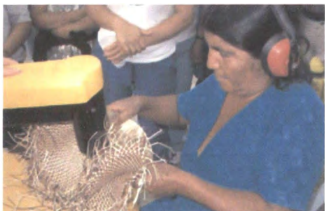
Asistencia técnica - Majadora eléctrica y protección auditiva.
